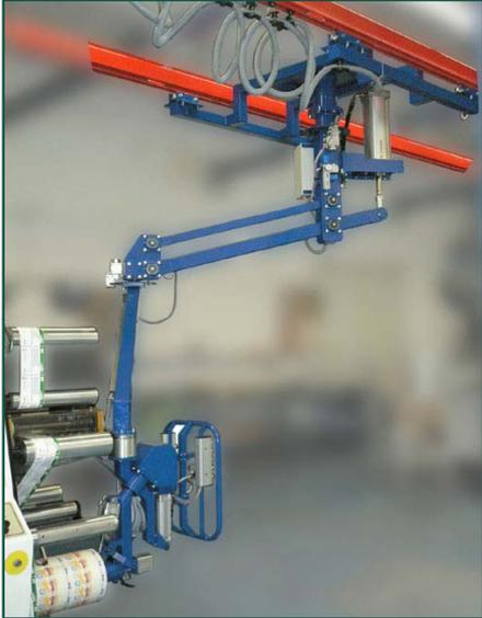
Schienen-verfahrbarer Manipulator mit Parallelogrammausleger, Huberzeugung durch Pneumatikzylinder
