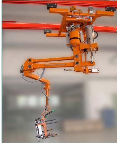
Schienenverfahrbarer Manipulator mit Parallelogrammausleger, Huberzeugung durch Pneumatikzylinder, Laufwagen mit integriertem Fahrtrieb und Bremse
