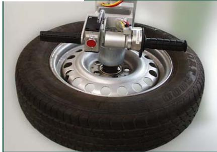
Der Drehgriff dient der pneumatischen Steuerung von Manipulatoren mittels Druckänderung. Die Anpassung des Regelbereiches erfolgt entsprechend den gewünschten Min - Max - Werten. Der Drehgriff wird am Bediengriff der Anlage bzw. des Greifers angebaut. Ein Null-Stellungsschalter ist optional erhältlich.
