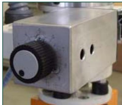
Der Drehselektor dient der pneumatischen Steuerung von Manipulatoren mittels Druckänderung. Die Anpassung des Regelbereiches erfolgt entsprechend den gewünschten Min / Max - Werten. Der Drehselektor wird am Bediengriff der Anlage bzw. des Greifers angebaut. Ein Null-Stellungsschalter ist optional erhältlich.
