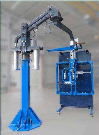
Säulenmanipulator mit Parallelogrammausleger, Huberzeugung durch 2 Pneumatikzylinder (stehend),
