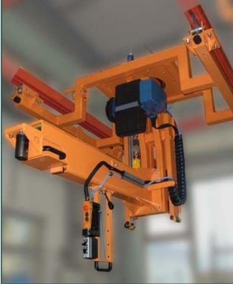
Schienenverfahbarer Manipulator mit Teleskopausleger, Huberzeugung durch Kettenzug
