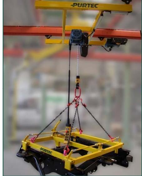
Kettenzug im Laufwagen mit Fahrtrieb verfahrbar in einem Schienen-System mit Greifer für Achsmodule
