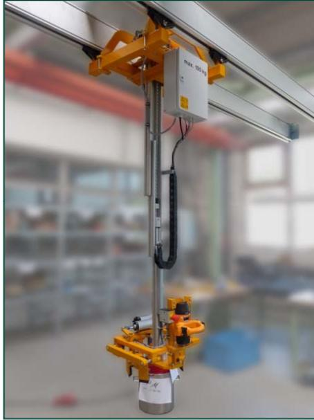
Schienenverfahbarer Manipulator mit Teleskop-Hubachse, Huberzeugung durch Kettenzug
