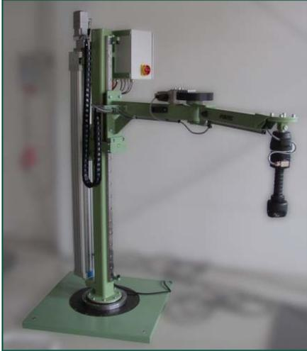
Hubsäule mit integriertem Z-Drehlager, Knickarmausleger, Huberzeugung durch elektr. Linearzylinder
