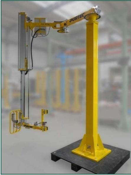
Säulenmanipulator mit Knickarmausleger, und starrer Hubachse, Huberzeugung durch Pneumatikzylinder
