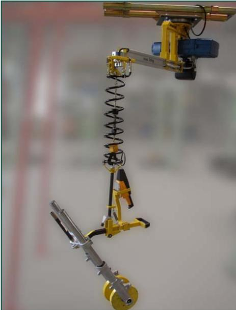
Schienenverfahbarer Manipulator mit Einfachausleger, Huberzeugung durch Kettenzug
