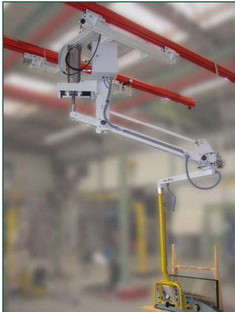
Schienenverfahrbarer Manipulator mit Parallelogrammausleger, Huberzeugung durch Pneumatikzylinder, Laufwagen mit iFahrtrieb
