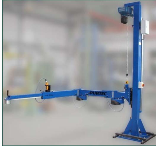
Hubsäule mit vorgesetztem Hauptdrehlager, Knickarmausleger und Teleskopausleger, Huberzeugung durch Kettenzug
