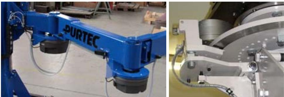
Die Bremse dient dem Sichern der jeweiligen Auslegerstellung. Die Ansteuerung kann über einen Bremstaster oder in Auswertung der Griffsteuerung per Lichtschranke erfolgen.
