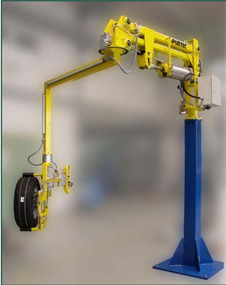
Säulenmanipulator mit Parallelogrammausleger, Huberzeugung durch Pneumatikzylinder (liegend)
