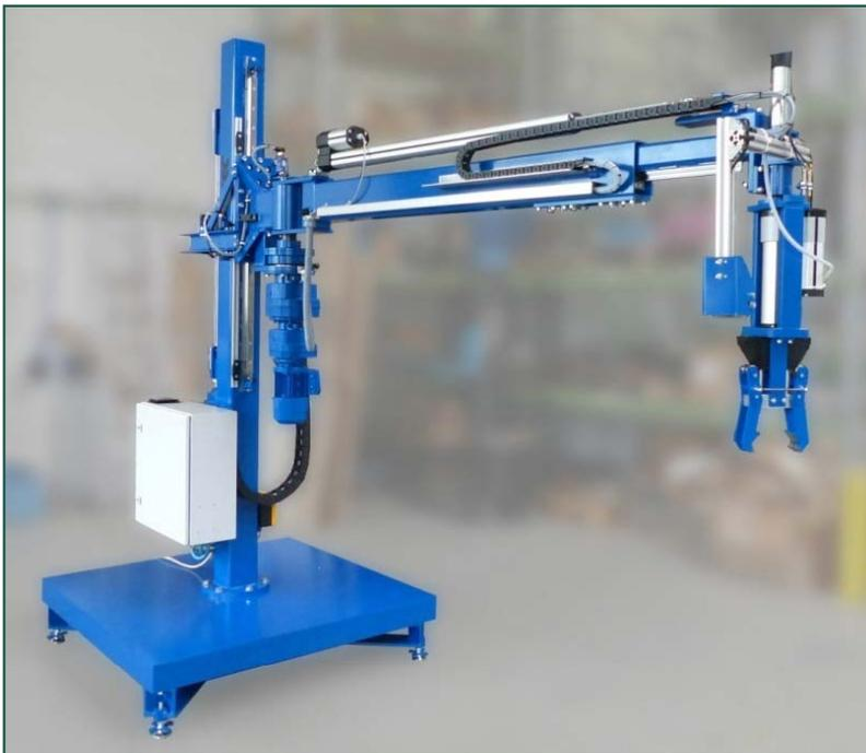
Hubsäule mit schwenkbarem Teleskopausleger, alle Bewegungen elektrisch angetrieben, Bedienung über Funkfernsteuerung mit Monitorüberwachung, stapelverfahrbare Bodenplatte
