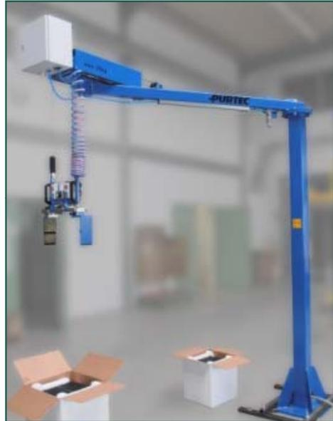
Säule mit starrem Ausleger, Huberzeugung durch pneumatischen Zylinder mit Balancersteuerung
