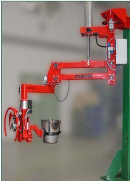
Hängend montierter Manipulator mit Parallelogrammausleger, Huberzeugung durch Pneumatikzylinder
