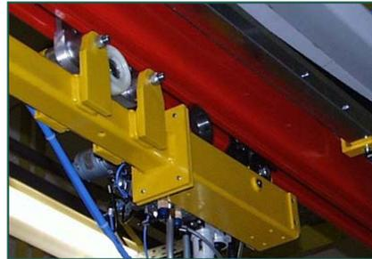
Der pneum. Fahrtrieb wird zum Verfahren von Laufwagen und Manipulatoren innerhalb eines Schienensystems eingesetzt. Er besteht im wesentlichen aus einem einrückbaren und mittels Druckluftmotor und Planetengetriebe angetriebenen Reibrad.
