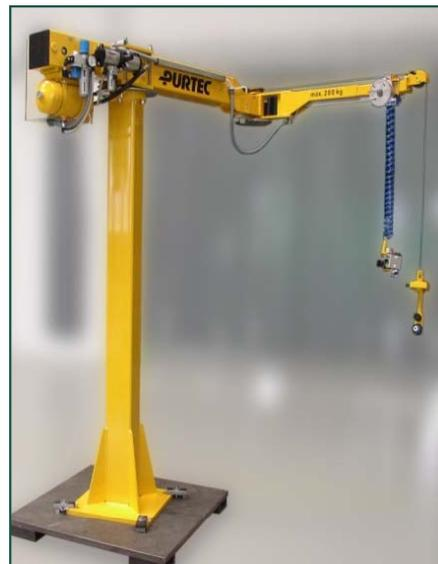
Säulenmanipulator mit Knickarmausleger, Huberzeugung durch innenliegenden Pneumatikzylinder
