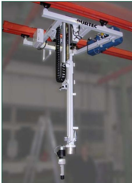
Schienenverfahbarer Manipulator mit starrer Hubachse, Huberzeugung durch pneumatischen Seilzug
