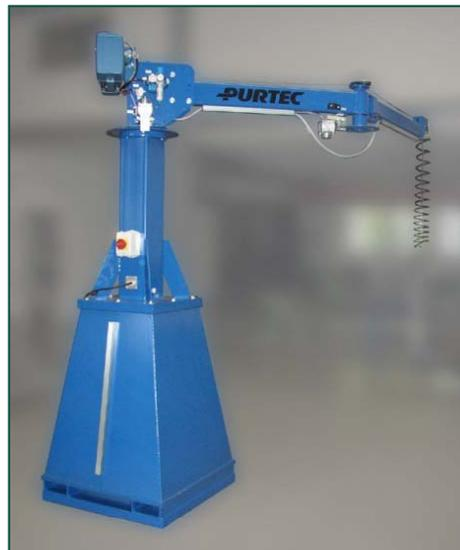
Säulenmanipulator mit Knickarmausleger, Huberzeugung durch elektrischen Seilzug, stabiler Stand ohne Dübelanker da Säulenfuß aufgelastet ist, Gesamtsystem staplerverfahbar
