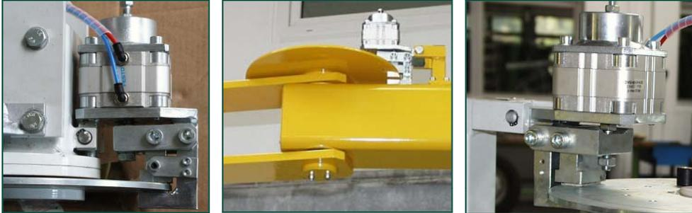
Die Bremse dient zum Bremsen der jeweiligen Dreh-Position (Parkstellung, Endstellung). Der Anbau der Bremse erfolgt am Drehlager an deiner jeweils angepassten Halterung. Durch Betätigen des Schalter „Bremse „1“ wird die Bremsscheibe über eine Bremszange blockiert und erst wieder durch einstellen Bremse „0“ freigegeben.
