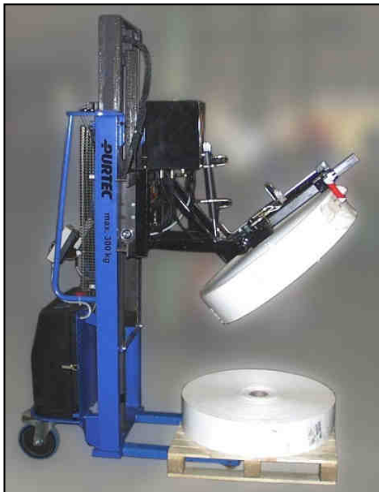
Hubwagen mit Schwenkvorrichtung (90°) für Folienspulen max. 300kg
