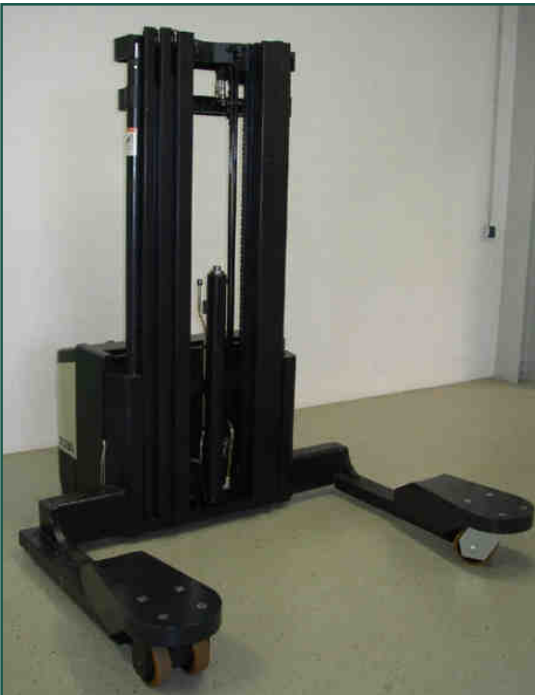
Elektrohydraulischer Hubwagen mit 4-Wegefahwerk, max. 1400 kg
