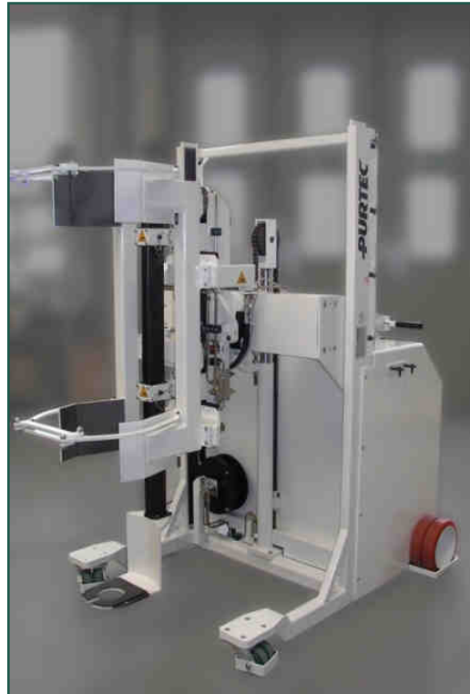
Elektrohydraulischer Hubwagen mit Außenspanngreifer zur Kristallentnahme, max. 250 kg, feinfühliges Fahrsteuerung über Sensorgriffe
