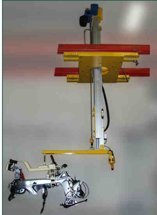
Schienenverfahbarer Manipulator mit starrer Hubachse, Huberzeugung durch Kettenzug
