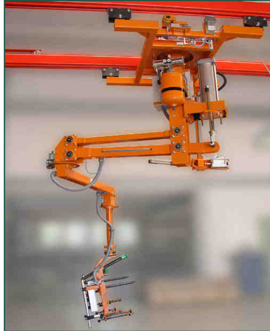
Schienenverfahrbare Manipulator mit Parallelogrammausleger, Huberzeugung durch Pneumatikzylinder, Laufwagen mit integriertem Fahrantrieb und Bremse
