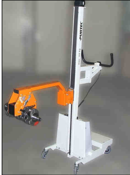
Elektromechanischer Hubwagen mit Kurbelwellen-greifer, max. 20 kg
