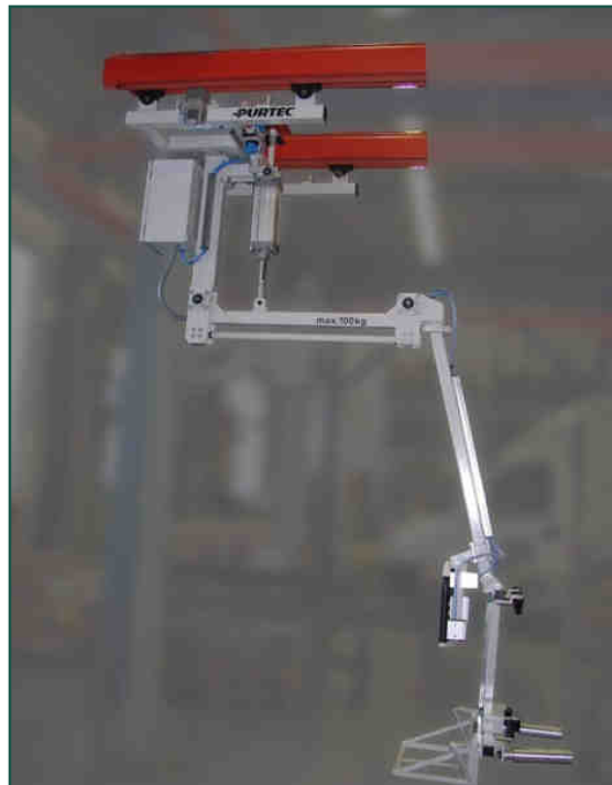
Schienenverfahrbare Manipulator mit Parallelogrammausleger, Huberzeugung durch Pneumatikzylinder, Laufwagen mit integriertem Bremse
