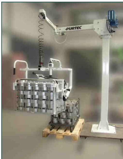
Säulenmanipulator mit Knickarmausleger, Huberzeugung durch elektrischen Seilzug mit Handkraftsteuerung, staplerverfahrbare Bodenplatte
