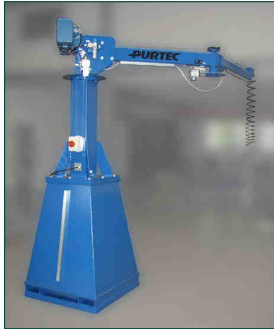
Säulenmanipulator mit Knickarmausleger, Huberzeugung durch elektrischen Seilzug, stabiler Stand ohne Dübelanker da Säulenfuß aufgelastet ist, Gesamtsystem staplervorfahrbar
