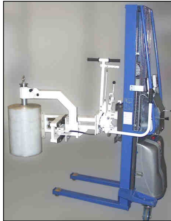
Hubwagen mit Hebevorrichtung für Folienspulen und mechanischer Schwenkvorrichtung (90°)
