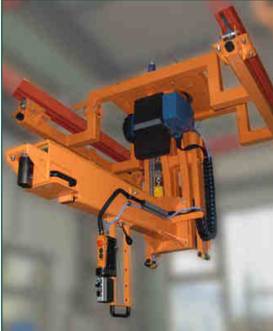
Schienenverfahrbarer Manipulator mit Teleskopausleger, Huberzeugung durch Kettenzug
