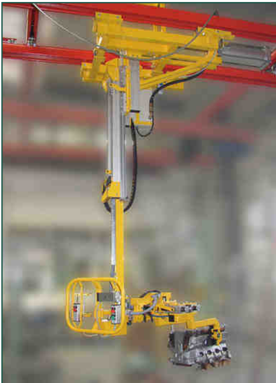
Schienenverfahbarer Manipulator mit starrer Hubachse, Huberzeugung durch liegenden Pneumatikzylinder mit Seilumlenkung
