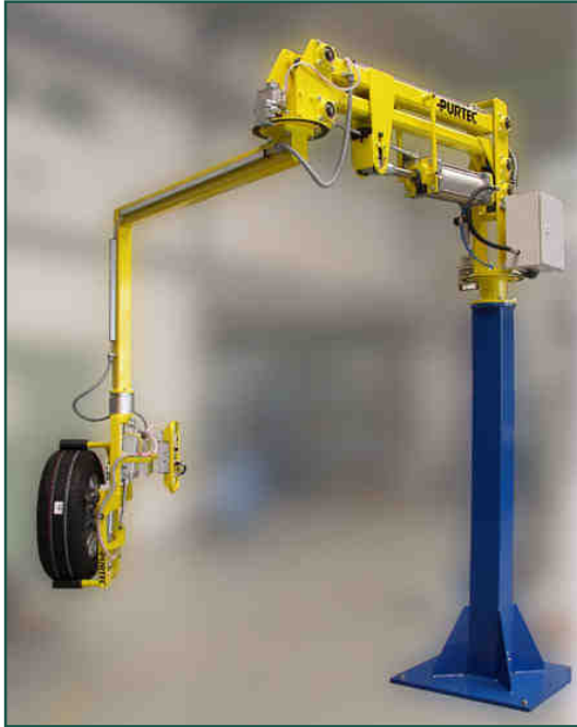
Säulenmanipulator mit Parallelogrammausleger, Huberzeugung durch Pneumatikzylinder (liegend)
