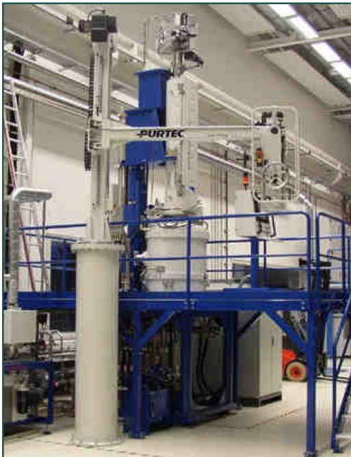
Säulenmanipulator mit starrem Ausleger, Huberzeugung durch elektrischen Kettenzug
