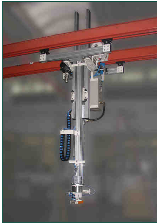
Schienenverfahbarer Manipulator mit starrer Hubachse, Huberzeugung durch Pneumatikzylinder
