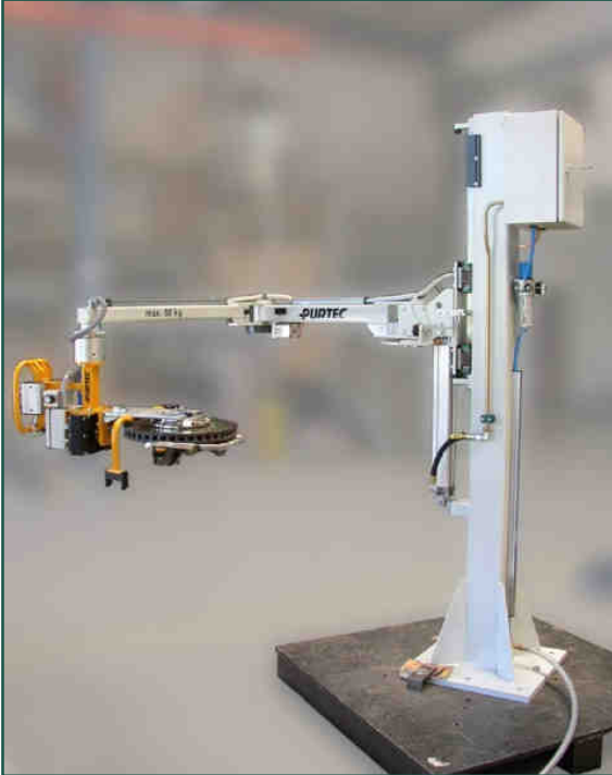
Hubsäule mit vorgesetztem Hauptdrehlager (vor Säule), Knickarmausleger, Huberzeugung durch Pneumatikzylinder
