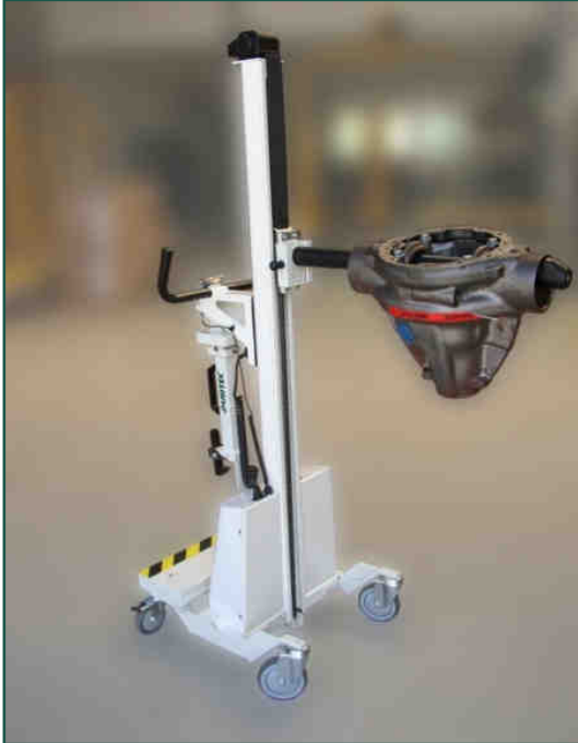
Elektromechanischer Hubwagen mit Aufnahmedorn für Differentialgehäuse, max. 35 kg
