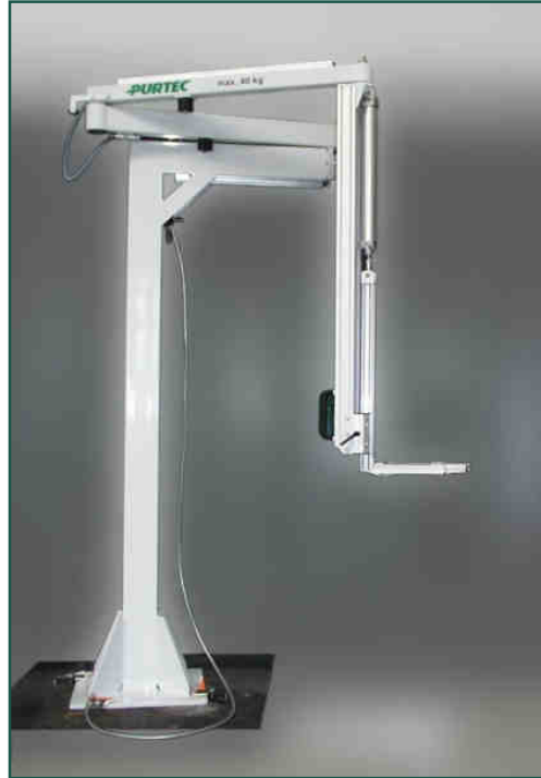
Säulenmanipulator mit abgewinkelter Säule und Knickarm-ausleger, Huberzeugung durch Pneumatikzylinder
