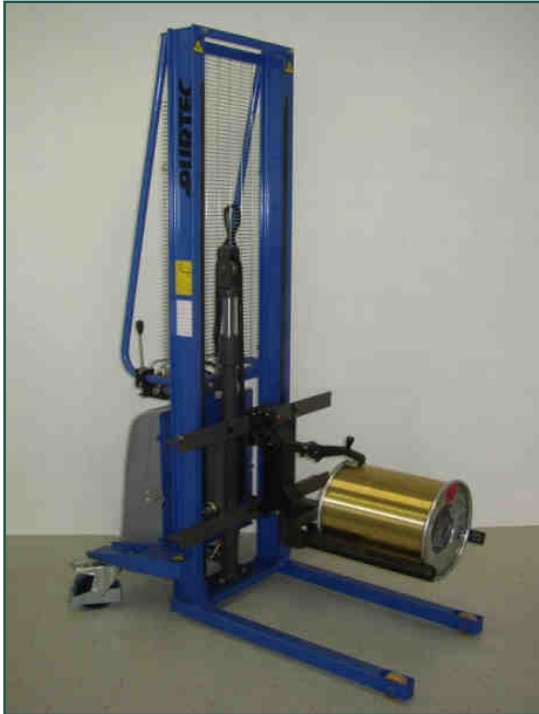
Elektrohydraulischer Hubwagen mit Spulen-aufnahme, max. 200 kg
