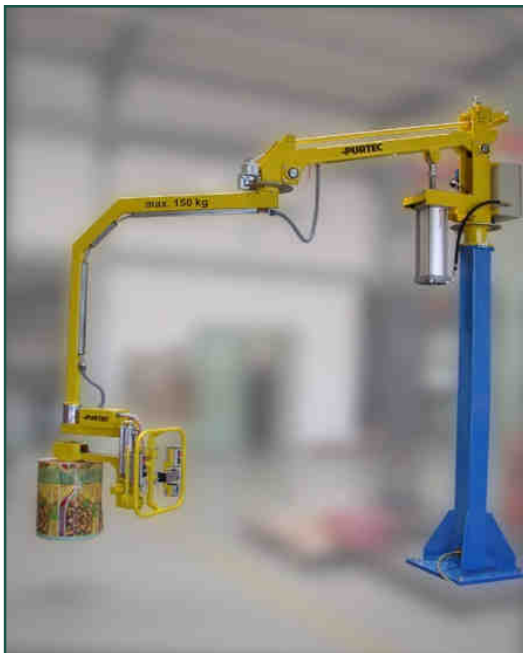
Säulenmanipulator mit Parallelogrammausleger, Huberzeugung durch Pneumatikzylinder (stehend), vorderer Ausleger hoch
