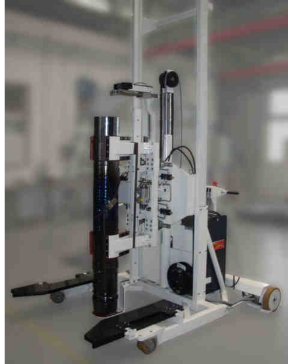
Elektrohydraulischer Hochhubwagen mit Außenspanngreifer zur Kristallentnahme, feinfühligste Fahrsteuerung über Sensorgriffe, elektr. Abschneidvorrichtung, max. 250 kg
