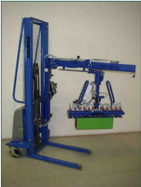
Elektrohydraulischer Hubwagen mit teleskopierbaren schwenkbaren Ausleger und Sauggreifer für Quaderabschnitte, max. 100 kg
