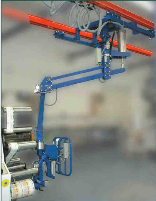
Schienen-verfahrbare Manipulator mit Parallelogrammausleger, Huberzeugung durch Pneumatikzylinder
