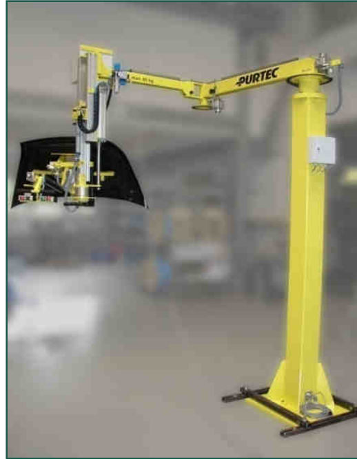
Säulenmanipulator mit Knickarmausleger und starrer Hubachse am vorderen Arm, Huberzeugung durch Pneumatikzylinder
