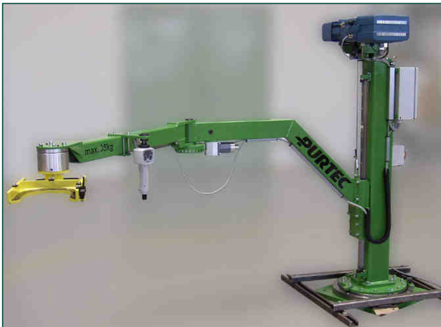
Hubsäule mit integriertem Hauptdrehlager, Knickarmausleger mit elektrischer Rastung, Huberzeugung durch elektrischen Seilbalancer mit Handkraftsteuerung
