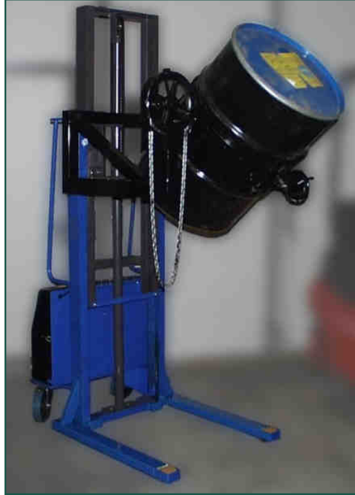
Elektrohydraulischer Hubwagen mit mechanischer Faßwendevorrichtung, max. 300 kg
