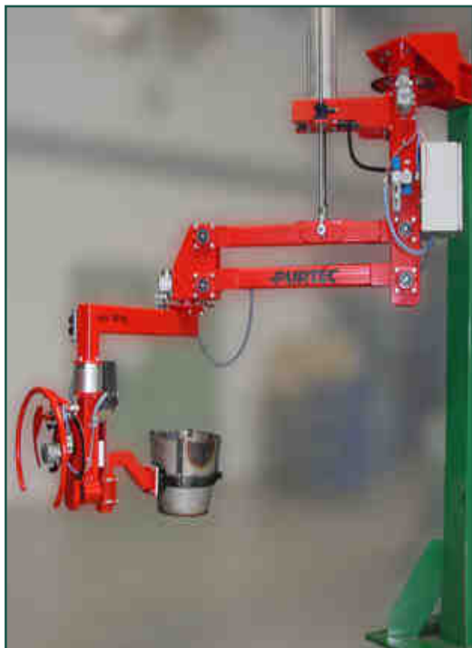
Hängend montierter Manipulator mit Parallelogrammausleger, Huberzeugung durch Pneumatikzylinder
