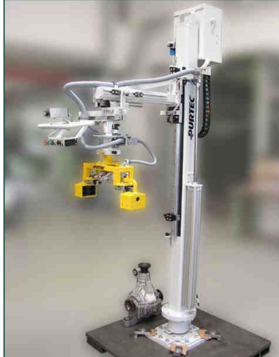
Hubsäule mit integriertem Hauptdrehlager und kurzem Teleskopausleger, Huberzeugung durch Pneumatikzylinder
