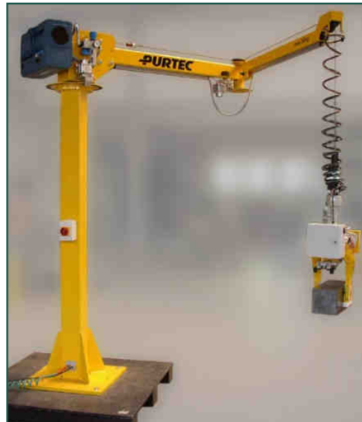
Säulenmanipulator mit Knickarmausleger, Huberzeugung durch pneumatischen Seilzug
