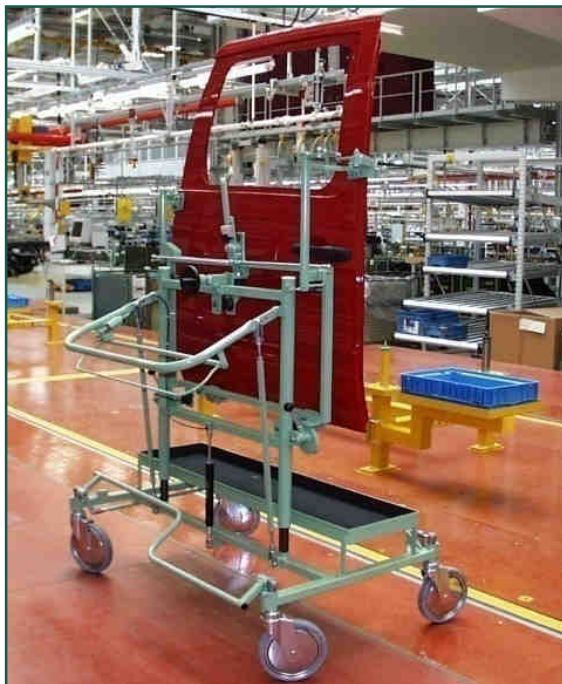
Gestellwagen mit Türhaltevorrichtung, max. 30 kg
