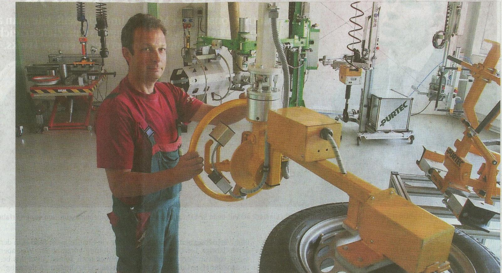
Die Manipulatoren der Firma Purtec sollen beim Heben und Bewegen schwerer oder unhandlicher Gegenstände helfen. Werkstattleiter Uwe Mann führt eines der Geräte vor. Einige Maschinen der Königswarthaer Firma können Gewichte bis 500 Kilogramm heben.
